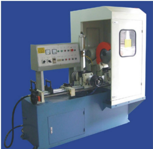
全自动切铝机铝材 切割机铝材开料机
